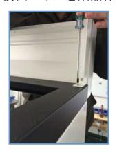
3.5 薬品保管棚本体に下層のフィルタモジュールを設置します。フィルタモジュールは金属プレートのある方が下になります。(HEPA 式フィルタモジュールは貼られているシールに上下区別の記載があります)下図参照:
